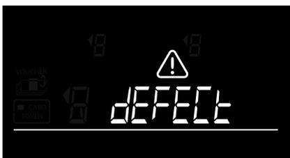
La cella di carica è difettosa, non è possibile eseguire alcuna operazione di conteggio/pesatura
