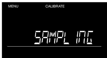
4 Posizionare un peso di 500 gr. sul piatto. Il display visualizzerà la dicitura "sampling" (campionamento) durante la procedura di calibrazione del dispositivo 6185.
