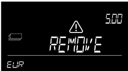
Valido solo per il conteggio delle banconote. Il peso sulla bilancia non è congruo a causa dell'elevata tolleranza di peso delle banconote - il 6185 non è in grado di determinare l'esatta quantità di banconote sul vassoio.
